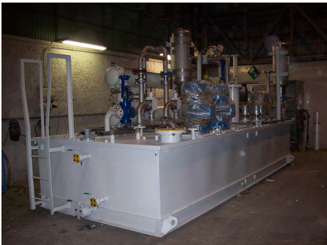
Costruzione con fornitura materiali centralina olio lubrificazione con cassa olio in carbonio e tubazioni in aisi.
